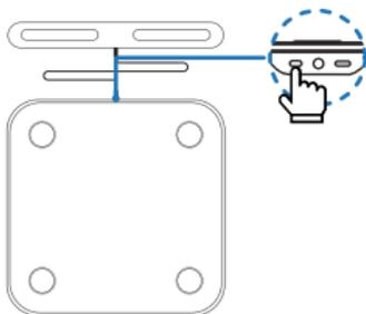
2. Laad de weegschaal ongeveer 2 uur met 5v/1A Lader.
