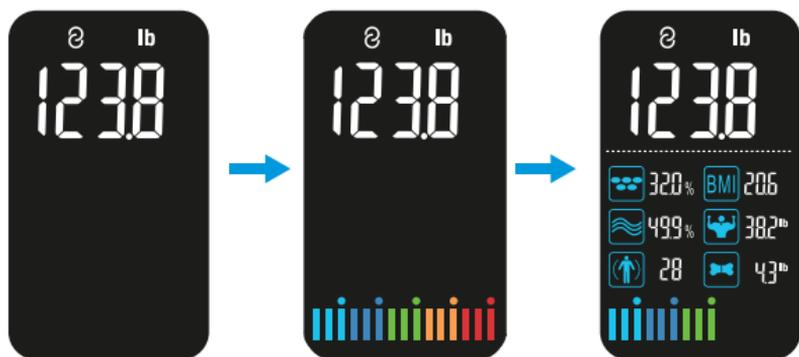
4. Die Waage schaltet sich automatisch ab, nachdem sie 15 Sekunden lang angezeigt hat.
